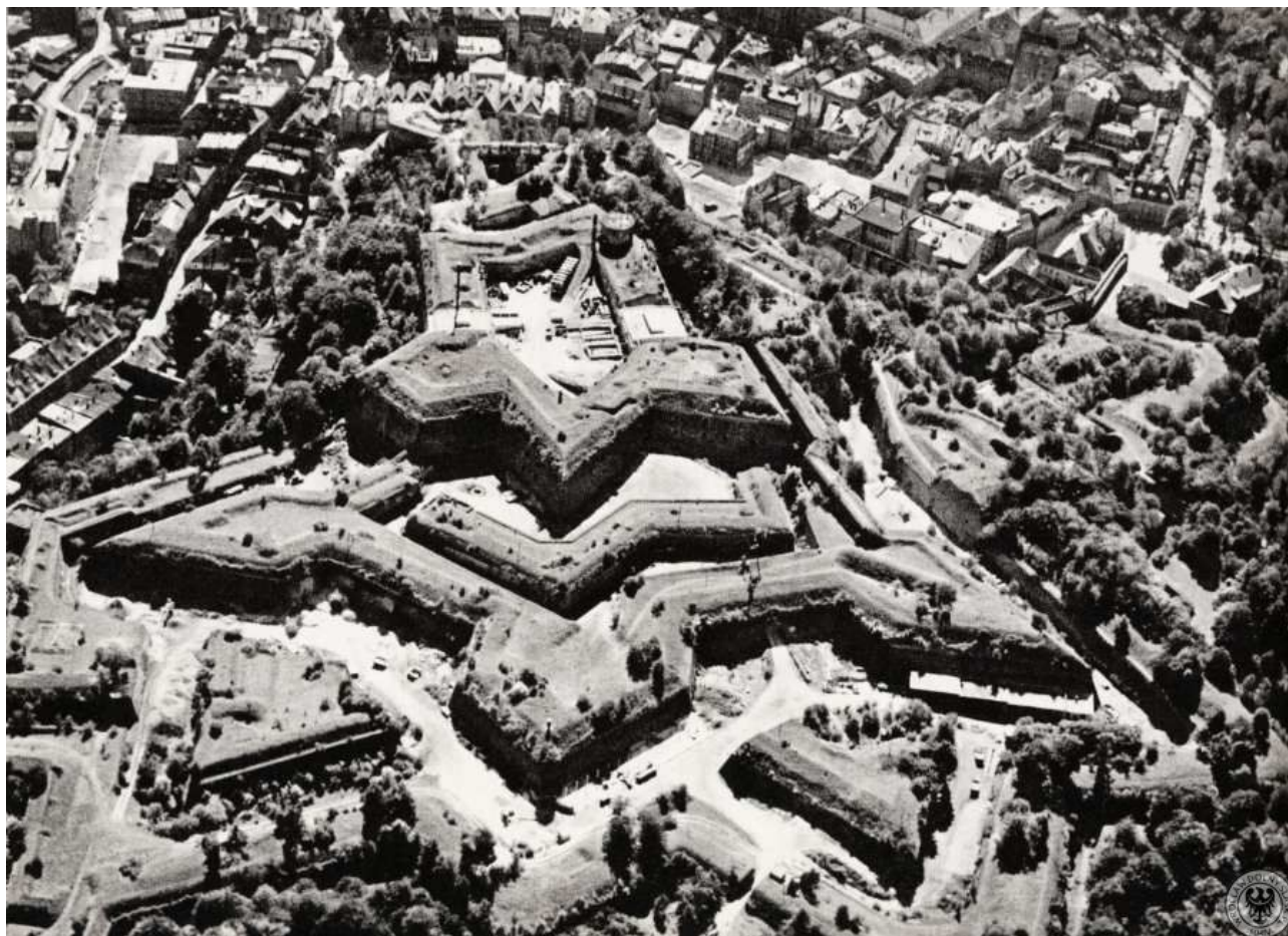
Forma wałów w latach 60. XX w. Na Donjonie powstały dwie hale z dachami lekkimi ze świetlikami które rozcięły wały koronowe. Zaburzano ciągłość i poziomy przekrycia ziemnego, wiele trawersów i kominów przebudowano.
