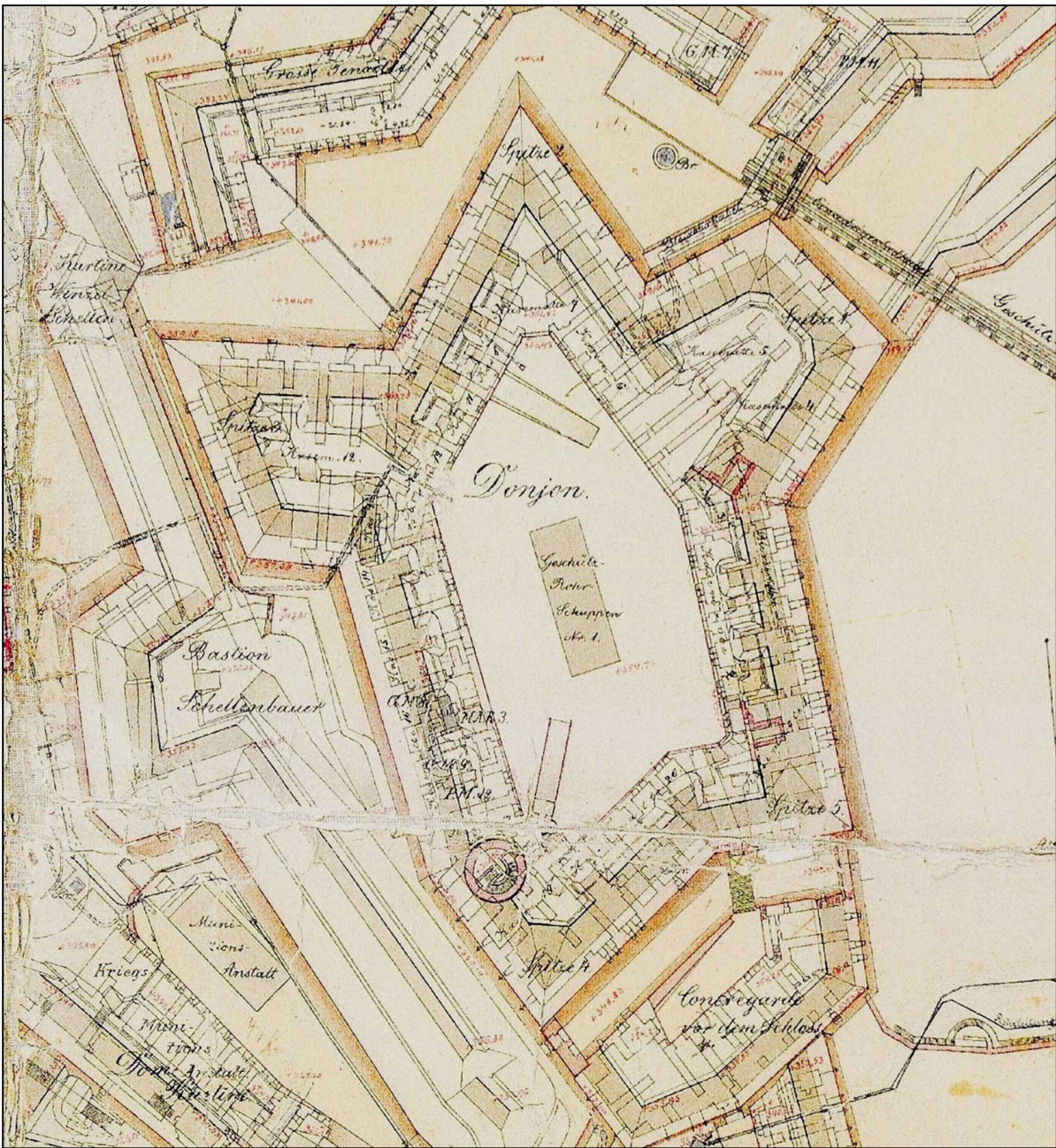
Rysunek 9 Plan wałów i kazamat z 1908 r. - z rzędnymi, bazowy plan dla rekonstrukcji stanu z pocz. XX w.
